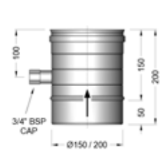
Flue Drain/Test Port (1 Per MVB)
